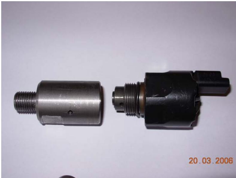
Rys. 12. Zawór redukcyjny z króćcem umożliwiającym sprawdzenie poprawności działania zaworu Fig. 12. The reducing valve with handle to making possible the validation of the valve acting
