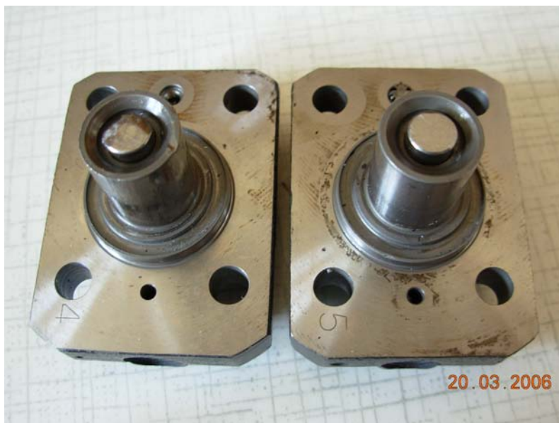
Rys. 13. Porównanie tłoczków uszkodzonej (z lewej) i nieuszkodzonej sekcji tłoczącej Fig. 13. The comparison of pistons of the damaged (from left) and free from damage pressing section
