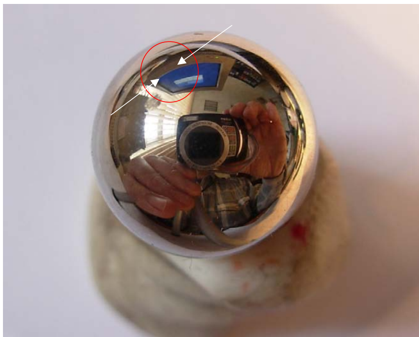
Rys. 5. Kulka z aparatu czterokulowego z widocznym śladem współpracy (zatarcia) Fig. 5. The ball from four-ball device with the visible trace interaction (seizing)
