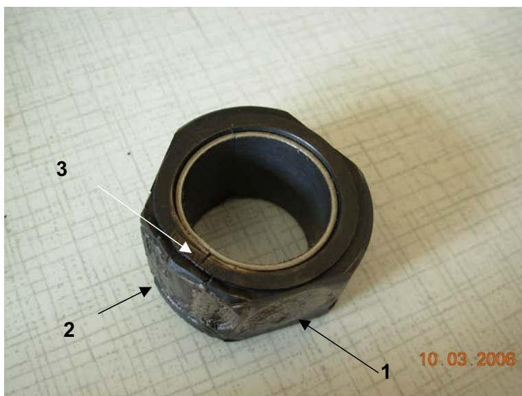
Rys. 9. Trójkątny popychacz ze śladami po uderzeniu o okrągły talerzyk Fig. 9. The triangular pusher with train after the shock for the round stick disk
