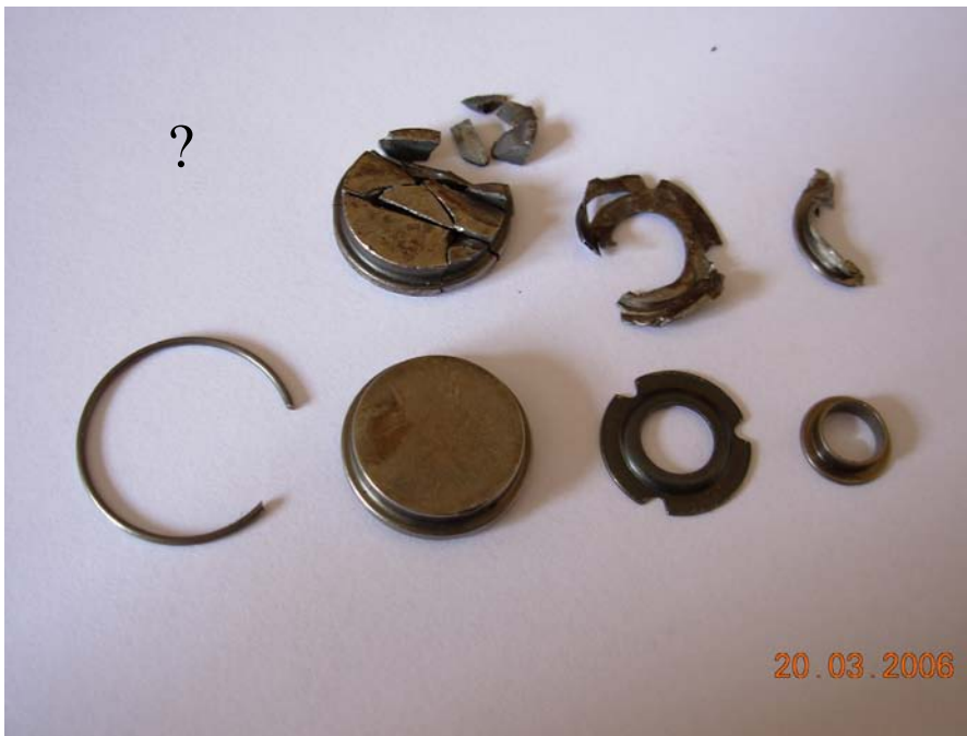
Rys. 8. Elementy prowadnicy zniszczone i ni zniszczone Fig. 8. Components of the guide worn out and not worn out
