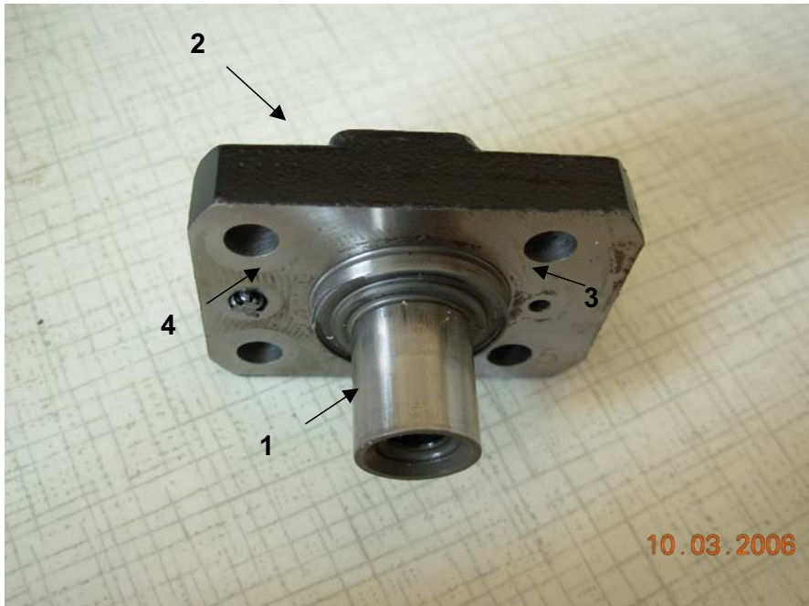
Rys. 7. Cylinderek i pokrywa sekcji tłoczącej, 1 – cylinderek, 2 – pokrywa, 3 – zawór ssący, 4 – zawór tłoczny Fig. 7. Cylinder and cover of pressing section 1 - the cylinder, 2 - covers, 3 - the suction valve, 4 - the forcing valve
