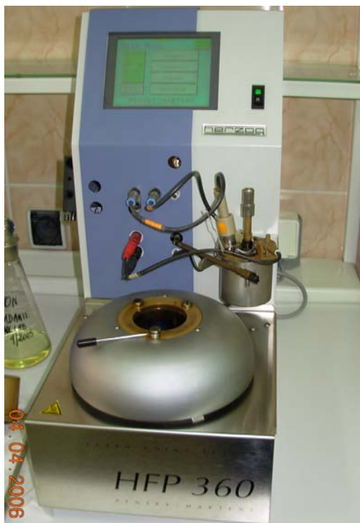
Rys. 3. Urządzenie HFP 360 do pomiaru temperatury zapłonu Fig. 3. The HFP 360 device for the measurement of the ignition temperature
